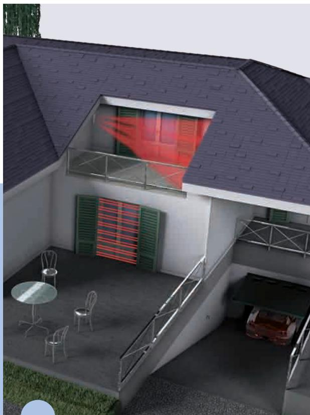
*Exemple de protection d'une terrasse avec détecteur à infrarouge passif*
